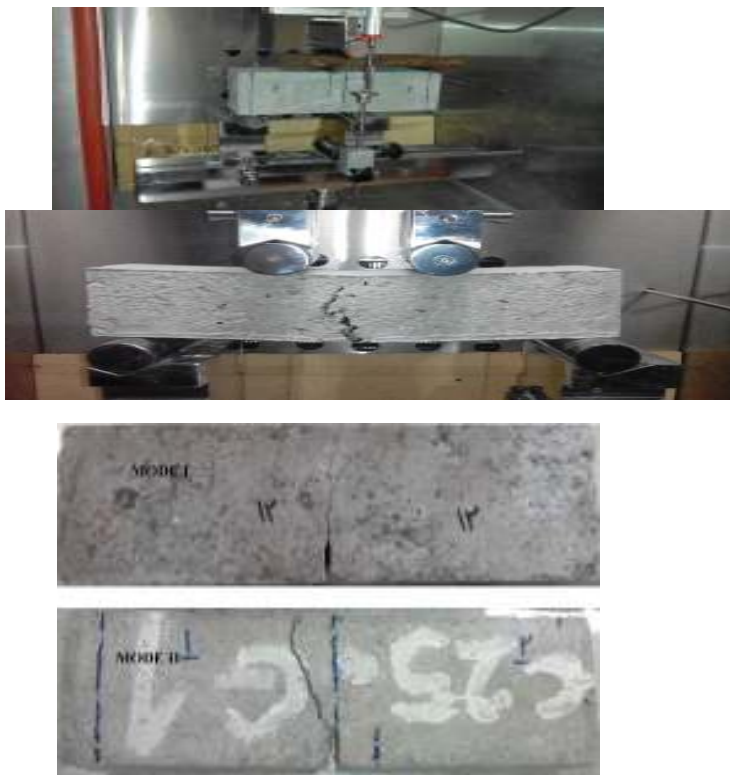
شکل ۱۱. دستگاه بارگذاری و شرایط تکیه گاه‌ها در مودهای شکست مختلف و نحوه شکست نمونه‌ها در مودهای مختلف
