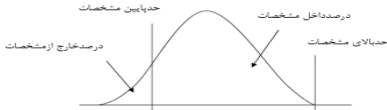
شکل ۲. رابطه بین پارامترهای داخل مشخصات (PWL) و درصد خارج از مشخصات (PD) [Radha, Nii ۲۰۰۶]
