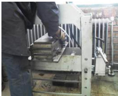
شکل ۱. نمایی از نحوه ساخت و تراکم دال
