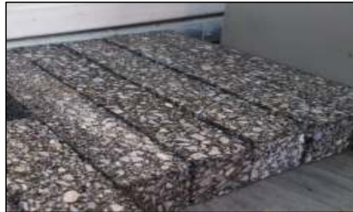
شکل ۳. نمونه تیرهای آسفالتی برش خورده
