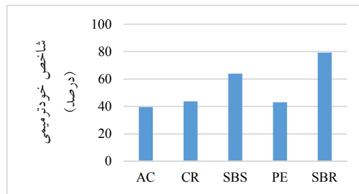
شکل ۸. شاخص خودترمیمی نمونه‌های حاوی ۵ درصد قیر
