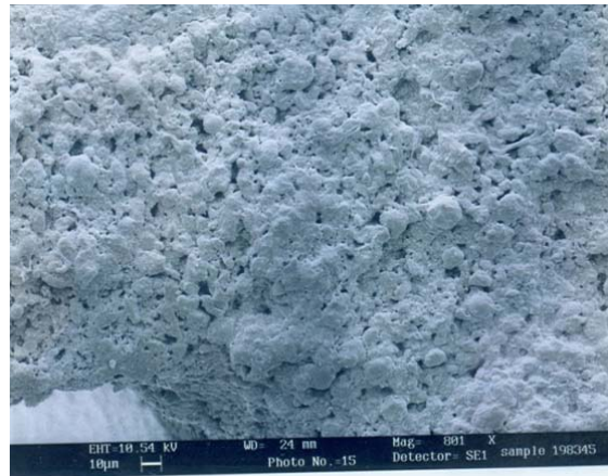
شکل ۳- تصویر تقاطع دو دیواره مونولیت لانه زنبوری با بزرگنمایی ۸۰۰ برابر
