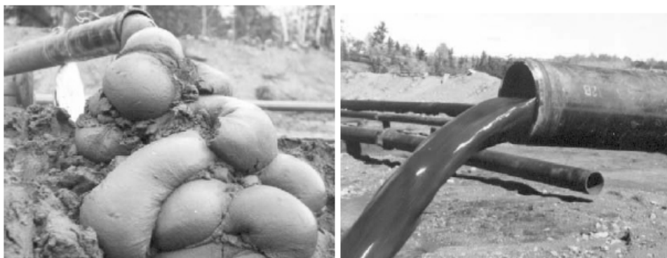
شکل ۱- مقایسه جریان و تخلیه باطله فرآوری مواد معدنی در دو حالت اسلاری و باطله خمیری
