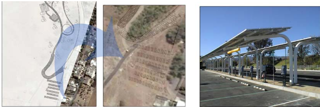
شکل ۵- طرح پارکینگ سایبانی خورشیدی با گنجایش ۶۰ دستگاه خودرو
