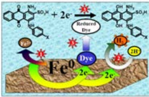
شکل ۲- تغییر شکل آهن برای واکنش با رنگ،
