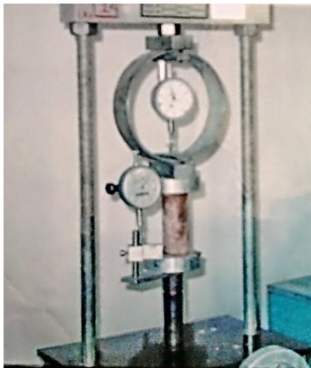
شکل ۵- نمایش نحوه انجام آزمایش تک محوری تعیین مقاومت فشاری خاک های رسی مخلوط با آهک
