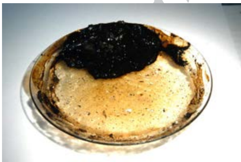
شکل ۵- جمع آوری پرلیت همراه نفت جذب شده از سطح آب
