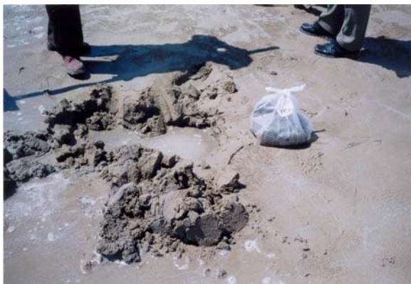
شکل ۵- اشباع بودن ماسه‌های ساحلی و ریزش رسوبات مانع از برداشت نمونه جهت تعیین وزن مخصوص می‌گردد.
