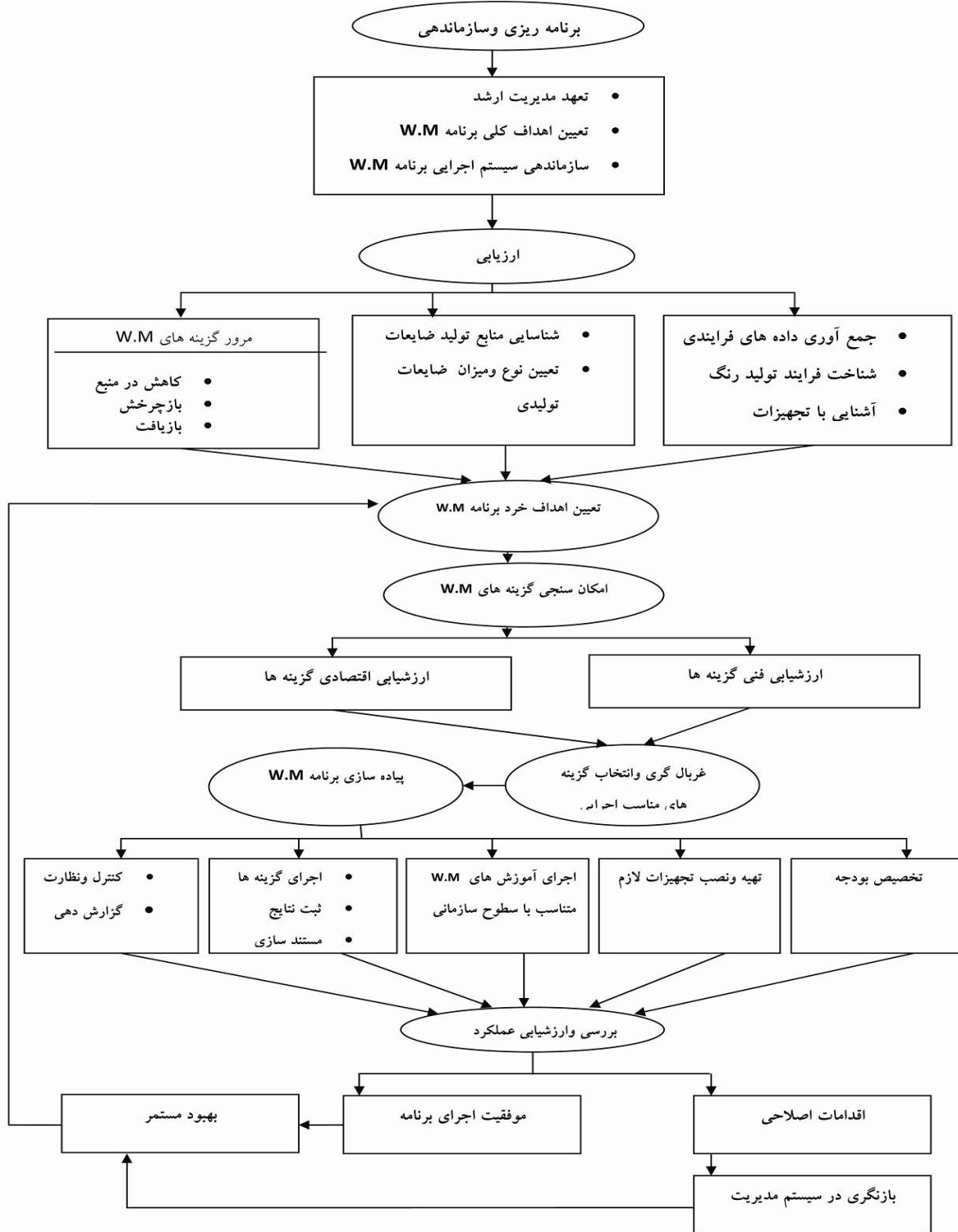
شکل ۳ - فلودیاگرام پیشنهادی سیستم مدیریت کمینه سازی ضایعات در صنایع رنگ سازی
