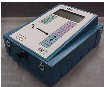
شکل ۱- نمای ظاهری دستگاه غبارسنج TSI
