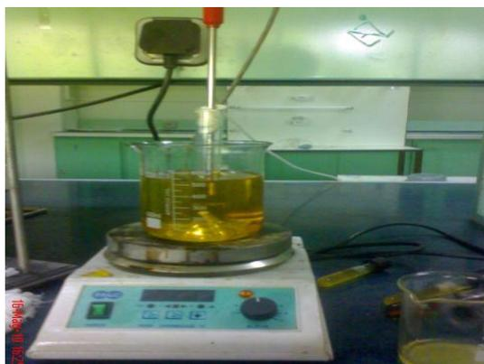
شکل ۲- دستگاه آماده‌سازی شده برای اندازه‌گیری نقطه‌ی آنیلین
