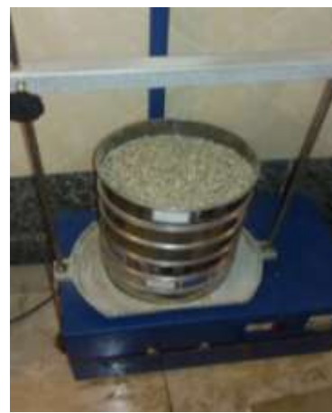
شکل ۳- الک‌های مورد استفاده جهت دانه‌بندی
