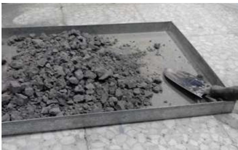
شکل ۲- سرباره‌های فولادی استفاده شده
