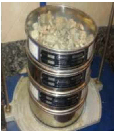
شکل ۳- الک‌های مورد استفاده جهت دانه‌بندی
