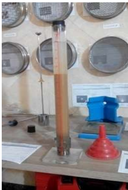
شکل ۶- نحوه قرائت عدد خاک و ماسه در آزمایش ارزش ماسه‌ای
