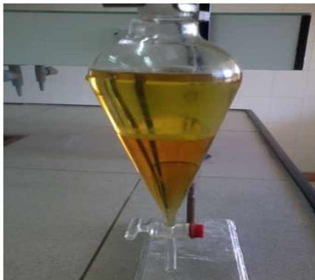
شکل ۱- بیودیزل و گلیسرول تولید شده از روغن خرما
