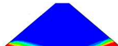
شکل ۵- ترک کششی ناشی از زلزله ی DUZCI با PGA= ۰/۶g Figure 5. The crack of Duzci earthquake, PGA: 0.6g
