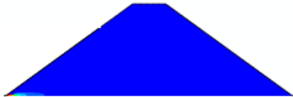
شکل ۴- ترک کششی ناشی از زلزله ی DUZCI با PGA= ۰/۳g
