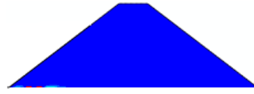
شکل ۳- ترک کششی ناشی از زلزله ی DUZCI با PGA= ۰/۱g
