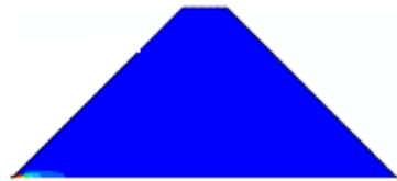
شکل ۱۲- ترک کششی ناشی از زلزله Loma Perita با ۰/۳ g
