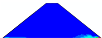
شکل ۸- ترک کششی ناشی از زلزله Kocaeli با PGA= ۰/۳ g Figure 8. The crack of Kocaeli earthquake, PGA: 0.3g
