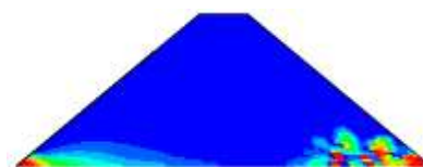
شکل ۹- ترک کششی ناشی از زلزله Kocaeli با PGA=۰/۶ g Figure 9. The crack of Kocaeli earthquake, PGA: 0.6g
