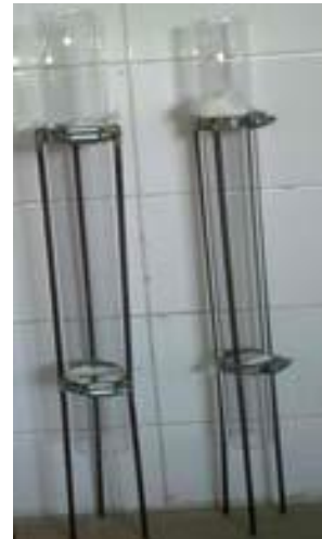
شکل ۲-لوله‌های داخلی با پایه فلزی Figure 2. Internal pipe with metal leg
