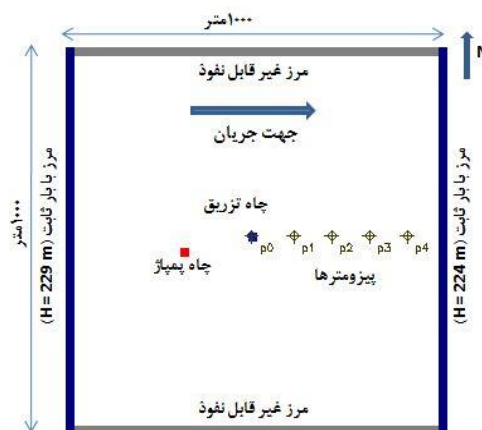
شکل ۲- مشخصات آبخوان فرضی مورد بررسی جهت شبیه‌سازی پمپ حرارتی مجهز به منبع آب زیرزمینی (GWHP).
