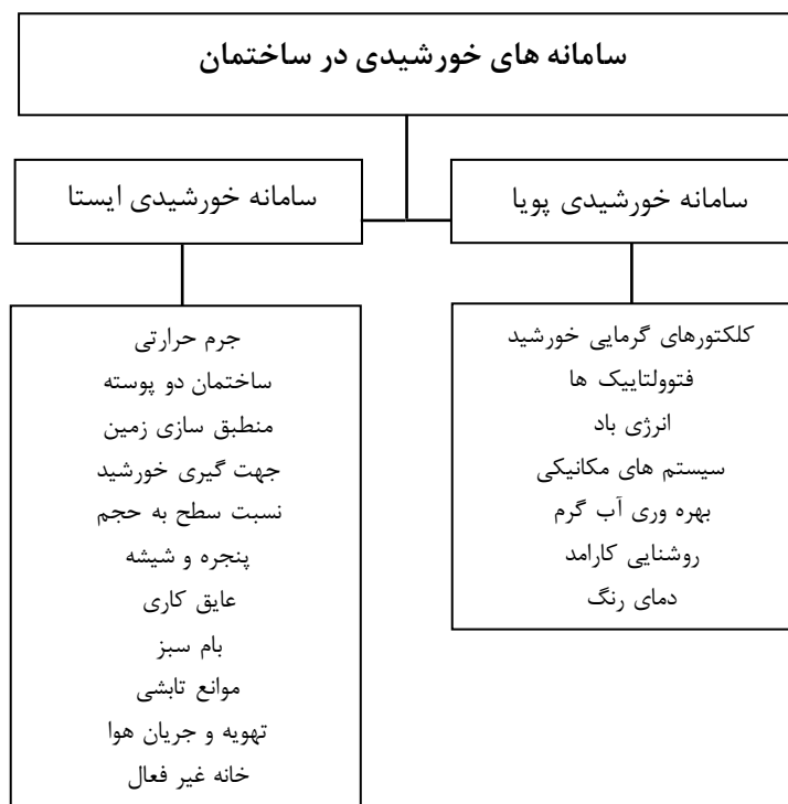
شکل ۲- انواع سامانه های خورشیدی در ساختمان
