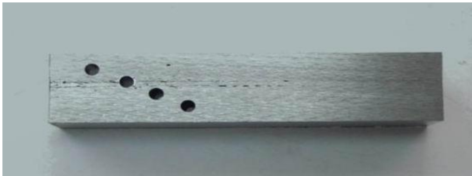
شکل ۹. قطعه سوم با ۴ بازتابنده
