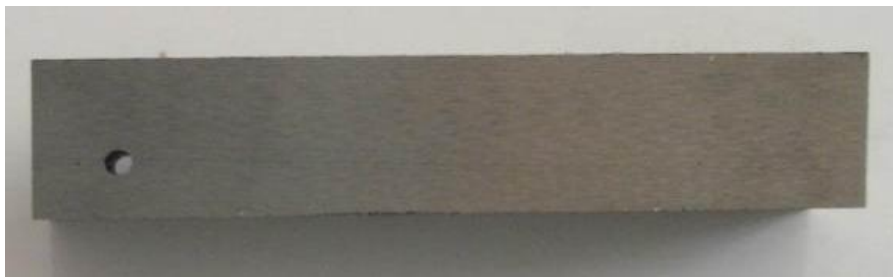
شکل ۵. قطعه اول با ۱ بازتابنده در نیمه پایینی
