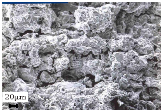
شکل ۹. ریز ترک‌های مشاهده شده در نواحی مرکزی سطح شکست، مربوط به فولاد D.AE با ۰/۳ درصد کربن در تنش متوسط ۲۵۰ MPa.
