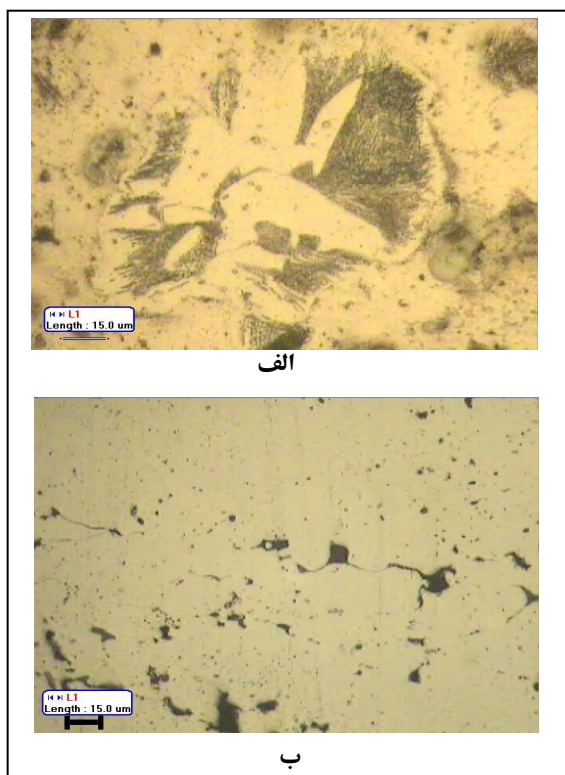
شکل ۳. افزایش کسر پرلیت موجود در ذرات پودر پایه در اثر افزایش میزان کربن الف) ۰/۳٪ و ب) ۰/۵٪ کربن
