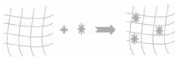
شکل ۱- شمایی از فرآیند اتصال به سطح. اشکال خورشیدی مانند پروتئین ها و صفحه مشبک سوبسترا می باشد
