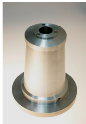
شکل ۳- اتاقک یونش چاهک‌دار ساخته شده
