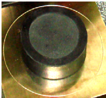
شکل ۳- نمونه ای از دیسک های لاستیکی مورد استفاده در آزمایش های مکانیکی در این مطالعه
