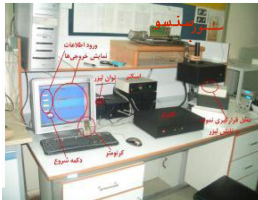
شکل ۲- نحوه قرار گیری اجزای سیستم لحیم کاری لیزری اتوماتیک
