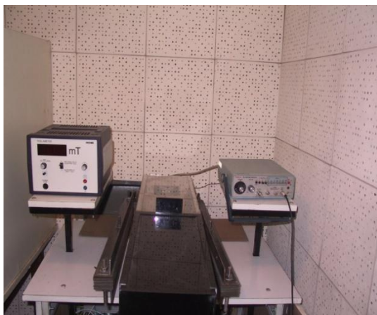
شکل ۲- بازوی مولد میدان در حالیکه جعبه شاتل در بین آنها قرار دارد.
