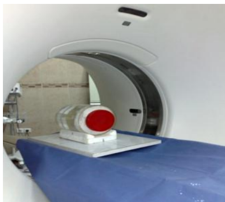
شکل ۳- نحوه قرار گرفتن فانتوم در داخل گانتری اسکنر سی تی
