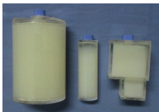
شکل ۱- تصاویری از فانتوم ناهمگن لگن و ظرف های ژل استفاده شده (ظرف ها پر از ژل پرتو دهی شده هستند)
