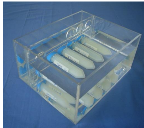
شکل ۲- نحوه قرار گیری تیوب های کالیبراسیون برای پرتودهی
