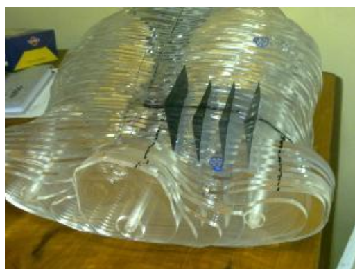
شکل ۲- محل دزیمترها در فانتوم که به ترتیب از سمت داخل به خارج بدن با شماره های ا تا ۷ نامگذاری شده است
