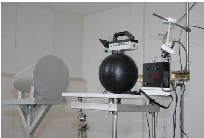
شکل ۴- تصویری از مخروط سایه طراحی و ساخته شده و پیکربندی مورد استفاده در اندازه‌گیری دز نوترون‌های پراکنده شده در آزمایشگاه کالیبراسیون نوترون پژوهشکده تحقیقات کشاورزی، پزشکی و صنعتی.
