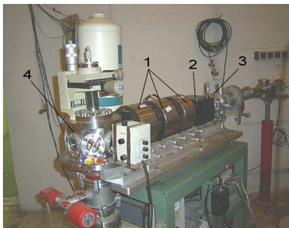
شکل ۱- تصویری از قسمتهای مختلف سیستم تولید باریکه میکرونی پروتون در این شکل نشان داده شده است: ۱- چهارقطبی مغناطیسی سه‌گانه ۲- جعبه روبش باریکه پروتون ۳- دیافراگم هم‌راستاساز ۴- محفظه آنالیز نمونه.
