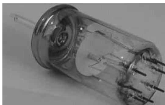
شکل ۲- دیود خلاء برای تست کاتد.
