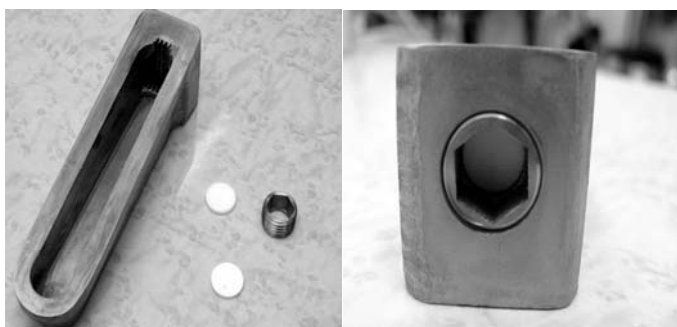
شکل ۱- نگهدارنده هدف جامد و قرص‌های تهیه شده از نیترات و کلرید استرانسیوم.
