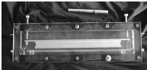
شکل ۴- آشکارساز آزمایشی ساخته شده برای به دست آوردن بهترین وضعیت قرارگیری آند و کاتد نسبت به هم.
