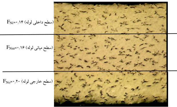
شکل ۱۱. جهت گیری هیدرید در قسمت های مختلف نمونه ی نورد کاری ۴ مرحله ای ( \times 100 ).
