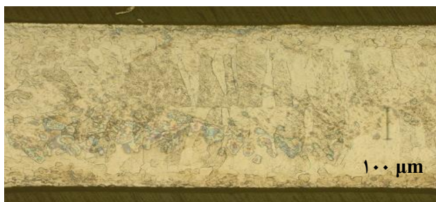
شکل ۶. ریزساختار دکمه‌ی جوش آلیاژ Zr-1%Nb، جریان ۱٫۳ کیلوآمپر، زمان ۳ چرخه و نیروی الکتروود ۳۵۰ نیوتن.
