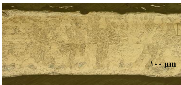
شکل ۵. ریزساختار دکمه‌ی جوش آلیاژ Zr-1%Nb، جریان ۲٫۵ کیلوآمپر، زمان ۳ چرخه و نیروی الکتروود ۳۰۰ نیوتن.
