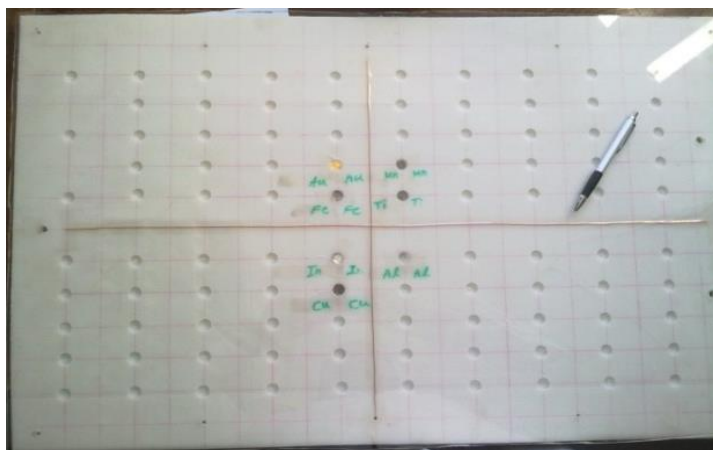
شکل ۴. صفحه‌ی پلی اتیلنی، پولک‌ها و سیم‌های مسی استفاده شده برای تعیین طیف و توزیع شار نوترون در استخر شماره ۲.
