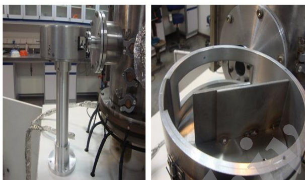
شکل ۷. چیدمان آزمایش و نحوه‌ی قرارگیری طیف‌سنج و دستگاه پلاسمای کانونی شریف.
