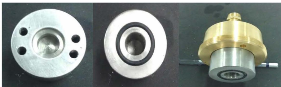
شکل ۶. نمایی از بدنه‌ی هدف مایع ساخته شده از جنس نیوبیم.
