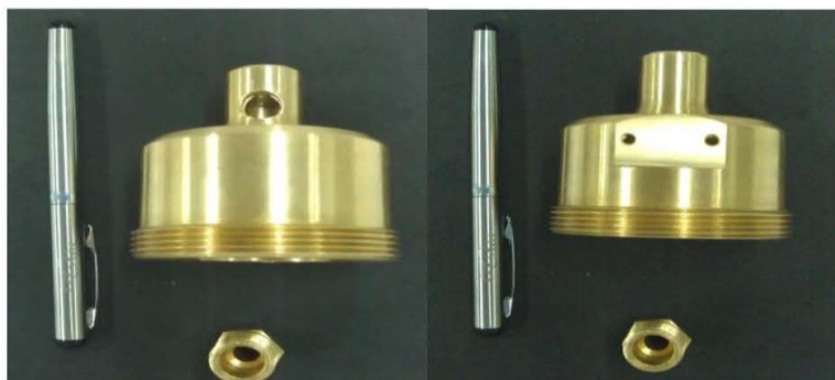
شکل ۸. نگه‌دارنده‌ی هدف مایع از جنس برنج.
