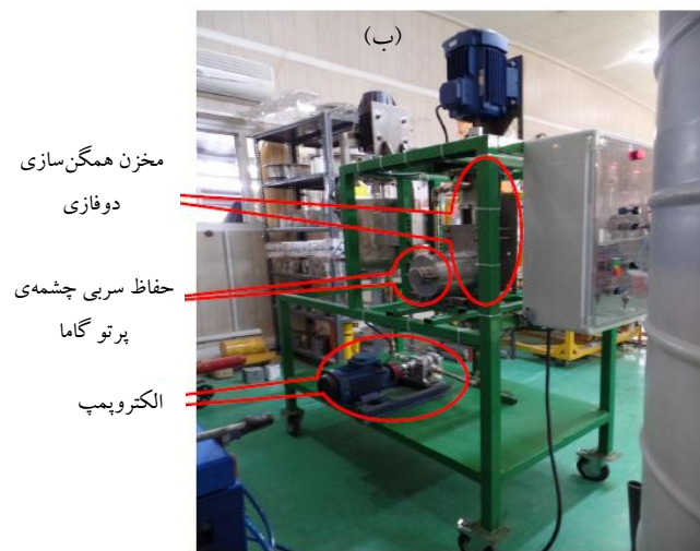
شکل ۲. الف) تصویر مربوط به نمای جلوی لوپ TPFHL، ب) تصویر مربوط به نمای پشتی لوپ TPFHL.
