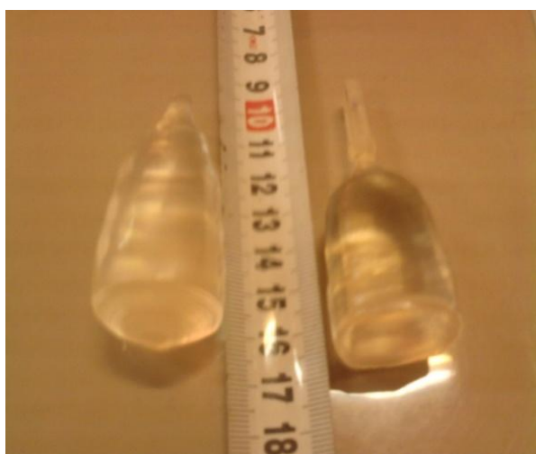
شکل ۲. تصاویر نمونه‌ای از بلورهای LiF:Mg,OH رشد داده شده به قطر تقریبی ۳cm، و طول ۴cm (بلور سمت راست) و ۶cm (بلور سمت چپ).
