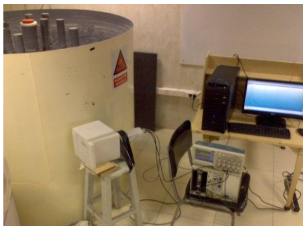
شکل ۲. چیدمان آزمایش PGNA و تجهیزات طیف‌نگاری استفاده شده در آزمایشگاه نوترون شهید دکتر شهریار.
