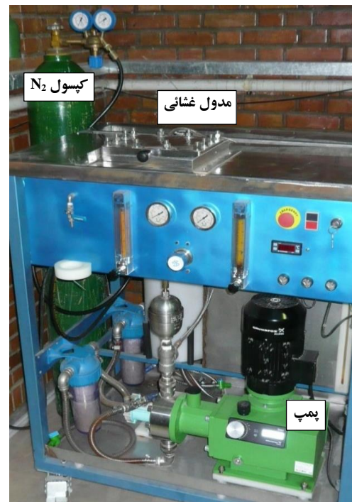
شکل ۳. تصویری از سیستم آزمایشگاهی ساخته شده.
