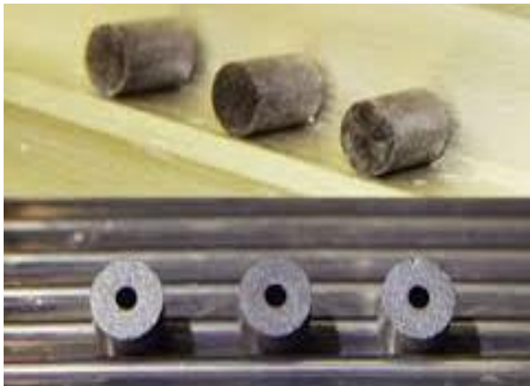
شکل ۱. نمونه‌ی قرص‌های توپر و حلقوی سوخت هسته‌ای.
