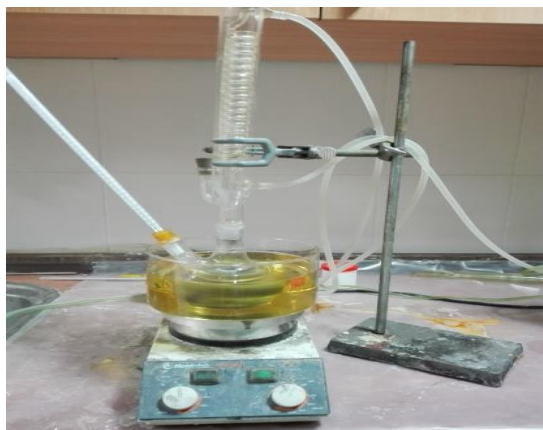
شکل ۵. نمایی از سیستم مبرددار برای انجام عملیات فروشویی.
