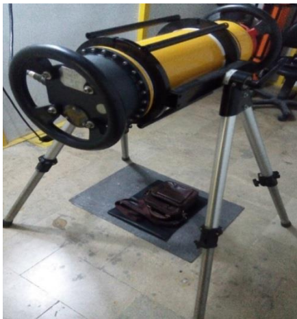
شکل ۲. نحوه‌ی قرارگیری کیف و صفحه‌ی تصویرگیر زیر لوله‌ی پرتو ایکس.
