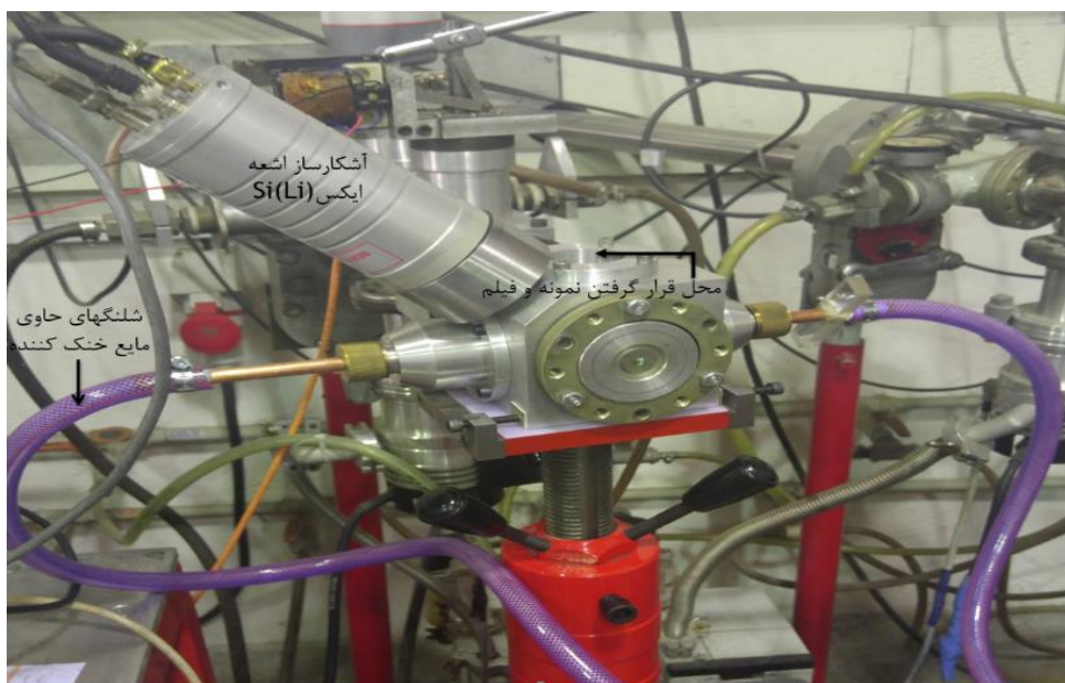
شکل ۴. محفظه‌ی برهم کنش به همراه آشکارساز پرتو ایکس و سیستم خنک‌سازی.
