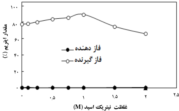
شکل ۶. اثر غلظت نیتریک اسید در فاز گیرنده بر روی انتقال Y(III).
