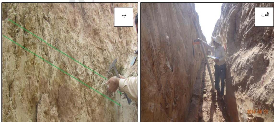
شکل ۹. الف) سنجش مقدار اورانیم دیواره‌ی ترانشه در فاصله‌های منظم با دستگاه طیف‌سنج؛ ب) نمونه‌برداری از لایه‌ی رسی سبز ترانشه.
