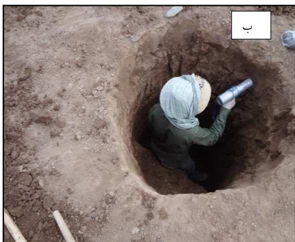
شکل ۵. روش حفر و برداشت چاهک در پلایای دق سرخ؛ الف) نمونه برداری شیاری به منظور تجزیه‌ی شیمیایی؛ ب) پرتوسنجی چاهک.
